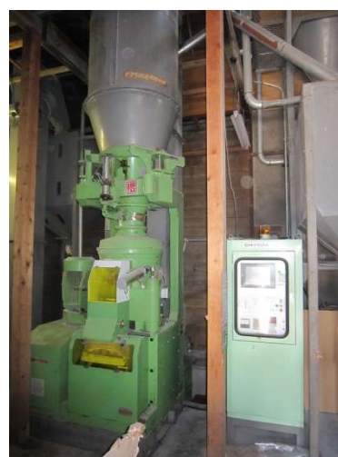
図4.8 精米機で高精白の酒米を作る
