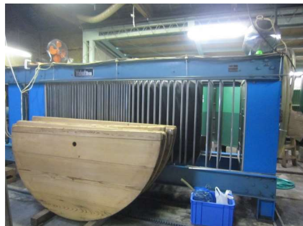
図 4.13 日本酒の絞り機 (すき間に袋を入れて、圧縮して絞る)
